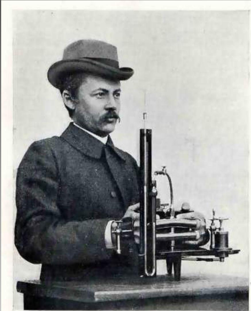
Fig. 29. — Sfigmomanometro per misurare la pressione del sangue nell'uomo.
