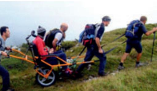
Un particolare veicolo, la Joelette, è stato messo a disposizione delle sezioni SAT per il trasporto sui sentieri di persone diversamente abili. Dotata di una ruota bene ammortizzata e di freni, questa portantina può essere manovrata da due operatori.
