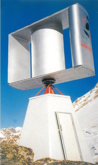
**Fig.8** - Aerogeneratore ad asse verticale
