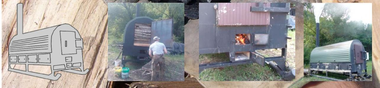
L'ulteriore evoluzione in tal senso è rappresentata dal prototipo creato nell'ambito del Progetto **RICACCI PIF FOGLIE**. Costituito da una struttura metallica di forma cilindrica posta su una slitta, spazio anteriore di combustione e camera di condensazione con canna fumaria. Questo modello consente, in particolare, la meccanizzazione delle fasi di carico e scarico.
