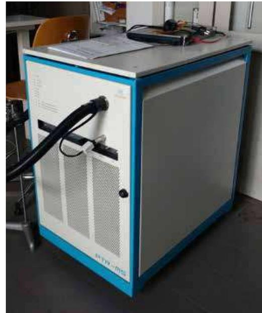
Figura 3. Spettmetro di massa con reazione a trasferimento di protoni (PTR-MS)- Foto Ibe CNR Bologna
