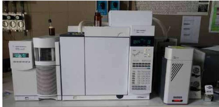
Figura 2. Tubi adsorbenti per l'analisi dei VOC (A) e Gas Cromatografo-Spettmetro di Massa (B) - Foto Ibe CNR-Bologna
